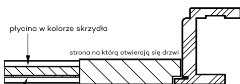
Drzwi ESTRA 10 z odwróconą przyłgą w wariantcie "Rewers"
